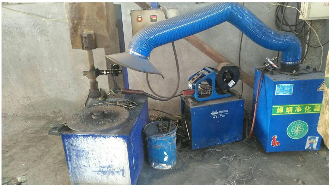
图 3-2 焊烟净化器
