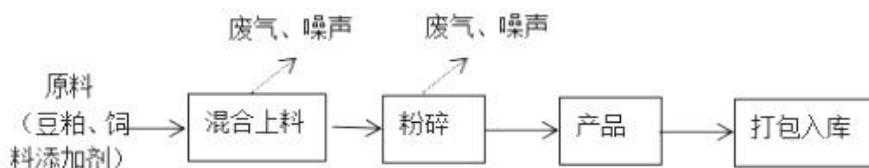
图 2-6 生产车间 3 生产工艺流程及产污环节图
