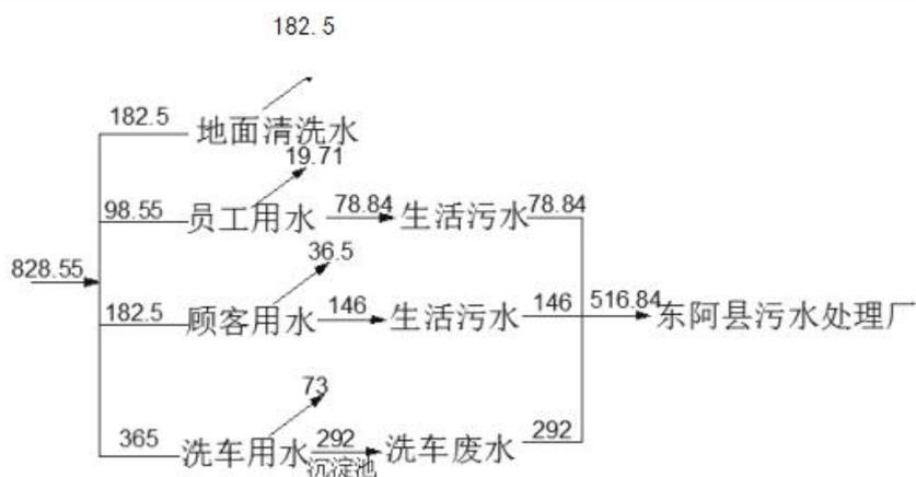
图 2-3 项目水平衡图 (m<sup>3</sup>/a)
